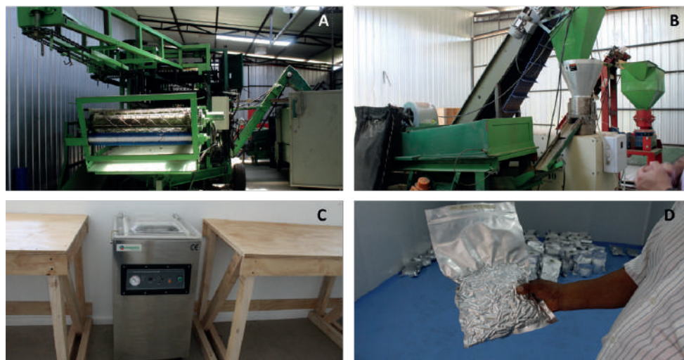
Figura 86. Equipamiento para la cosecha y almacenamiento de lúpulo: Máquina peladora de plantas (A), pelletizadora (B), selladora al vacío (C) y cámara de frío (D). Gentileza Lúpulos Hueimen.
